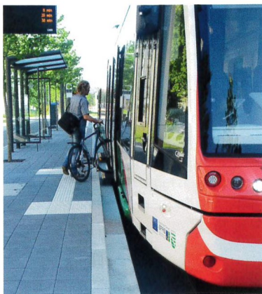
Abb. 3: Barrierefreier Einstieg mittels Variobord. Hier das praktische Beispiel am Stadlerplatz zu Chemnitz.
