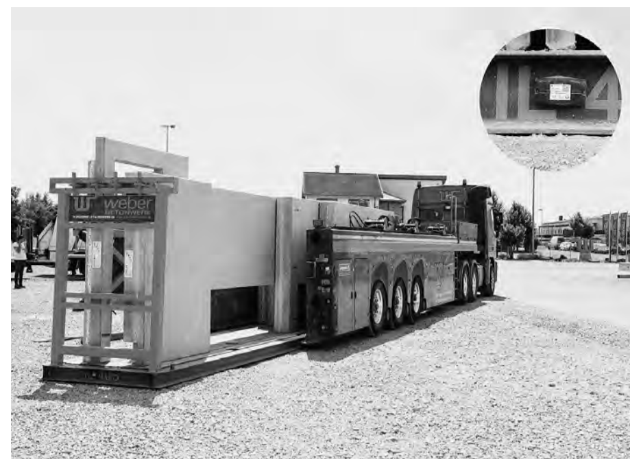
Durch die Digitalisierung von Ladungsträgern für Beton-Fertigelemente sind Kunden der Weber Betonwerke über den Status von Lieferungen und deren voraussichtliche Ankunft informiert. FOTO: WEBER
