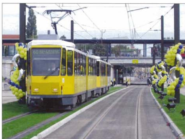
KT 4 D 6012+6112 verlassen am Eröffnungstag den Verknüpfungspunkt S Adlershof in Richtung Wissenschaftsstadt. Im Hintergrund ein S-Bahnzug der Baureihe 481/482. Der Oberbau besteht aus dem System „Rheda City Grün“ mit einbetonierten Zweiblockschwellen sowie „STRALastic“-Kammerelementen.
